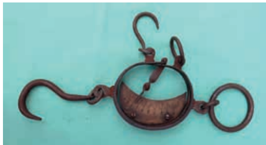
FOTO 14 Báscula-romana de media luna, está construida en hierro y bronce. Tiene dos escalas con dos agujas y según por donde se cuelgue, mide de 0 a 20 kg y de 10 a 100 kg.
