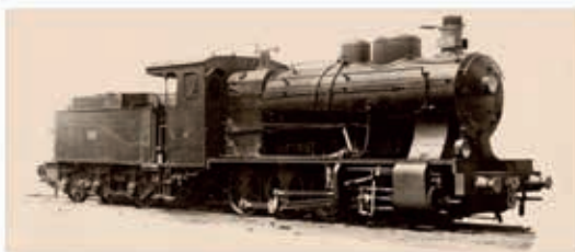
LOCOMOTORA MAZA SERIE 1001/1030 - RENFE SERIE 040-2441/040-2468. Fabricada por HENSCHEL, 1911-1913
